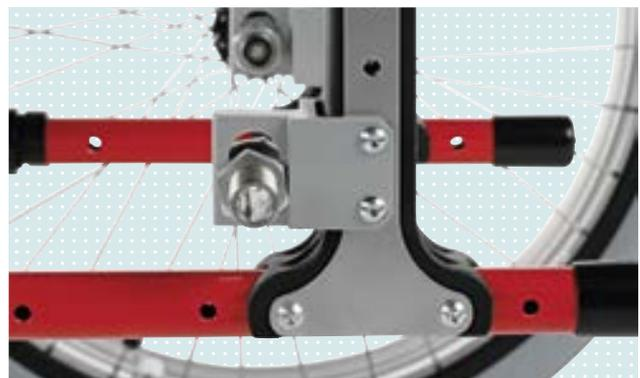
• Der Antriebsradadapter lässt sich auf kurzen /aktiven oder langen /passiven Radstand einstellen.
