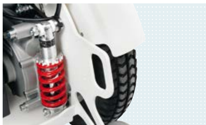
► Gefederte Antriebseinheit für zusätzlichen Fahrkomfort
