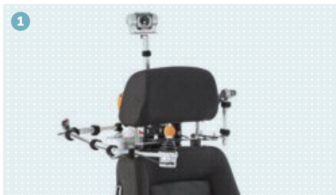
1 Kamerasystem mit Servosystem hinter dem Kopf
