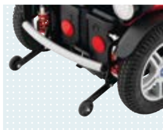
Gefederter Antriebsträger inklusive Batterieschubfach
