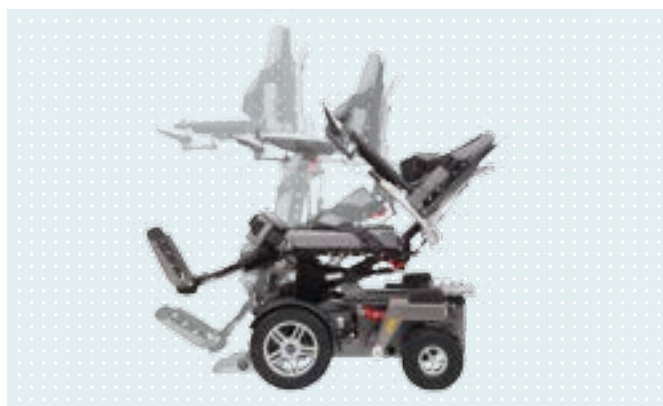
► Kombifunktion: aus der Halbliege in den Stand
