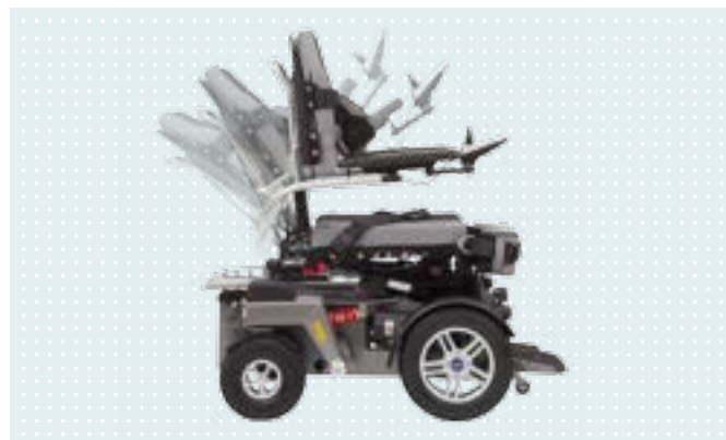
► Biomechanischer Rücken, bis zu 45° verstellbar
