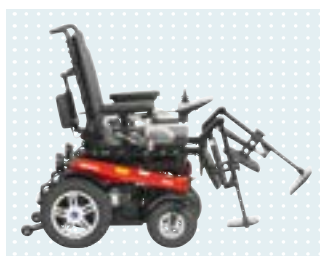
• Elektrisch winkelverstellbare Fußstützen
