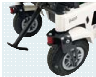
Kantensteighilfe, Überwindungshöhe bis zu 100 mm
