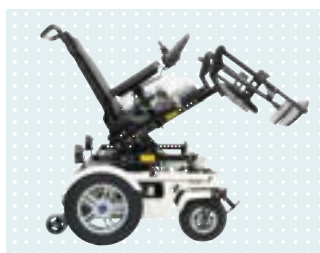
Manuelle Sitzkantelung, Gasdruckfeder, bis zu 20° stufenlos
