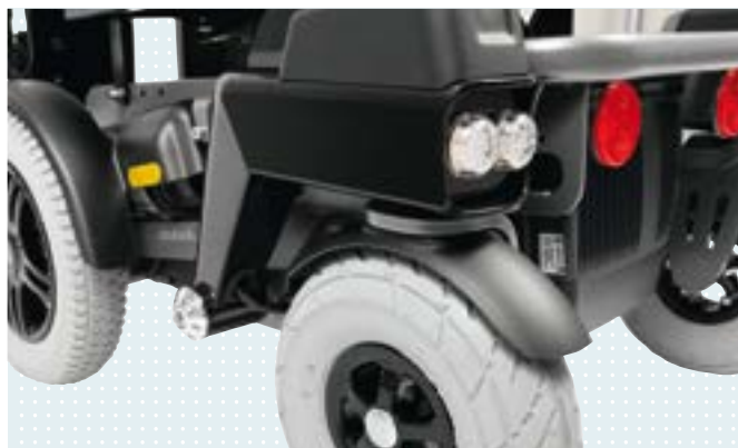
► Heckbeleuchtung: Integriert in der Lenkradschwinge
