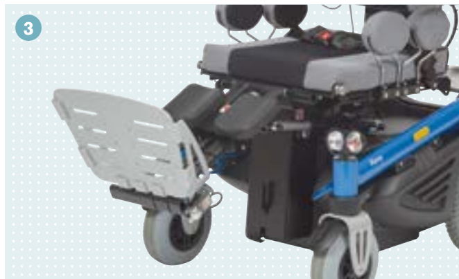
► Elektrisch verstellbare Beinstützen mit individuellem Beinlängenausgleich
